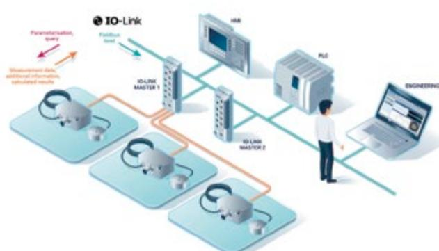
Senzori za merenje sila do 50 kN sa IO-linkom značajno olakšavaju digitalnu obradu signala. Oni mogu da identifikuju situacije u kojima su prekoračena tehnička ograničenja, na primer, maksimalno opterećenje i maksimalno dozvoljene vrednosti ili broj ciklusa, te mogu da upozore na potencijalni kvar ili otkazivanje sistema.
