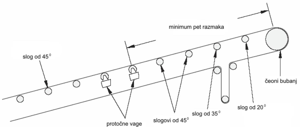
4. Vertikalno rastojanje čeonog bubnja u odnosu na centralni valjak susednog nosećeg sloga može biti maksimalno 13 mm, u slučaju kada je vaga u blizini čeonog bubnja.
