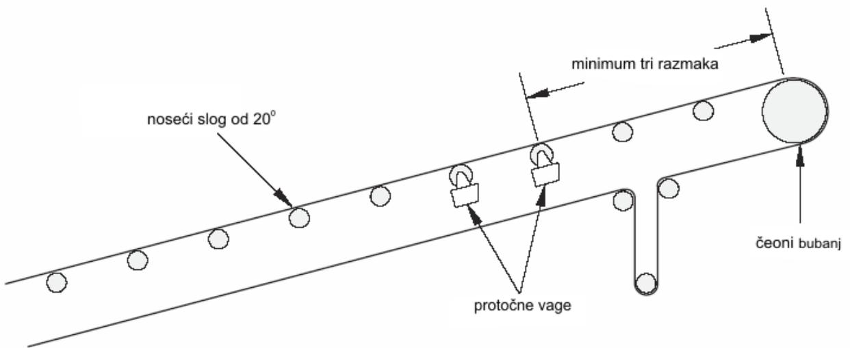
2. Na transportere sa nosećim slogovima sa uglom od  $35^{\circ}$ , ugraditi minimum dva noseća sloga od  $35^{\circ}$  i jedan od  $20^{\circ}$  između vage i čeonog bubnja.
