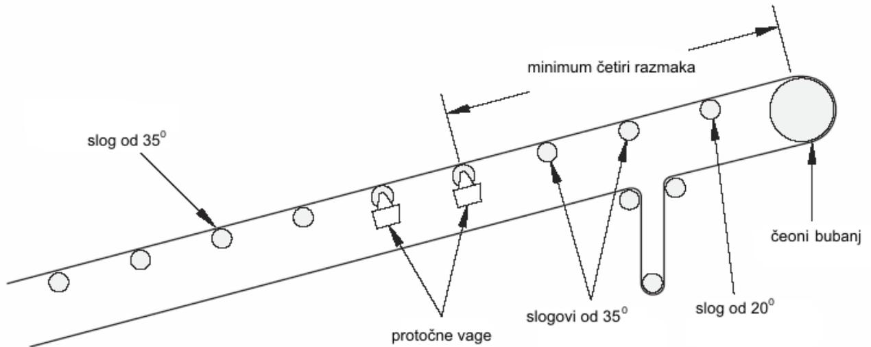
3. Na transportere sa nosećim valjcima sa uglom od  $45^\circ$ , ugraditi minimum dva noseća sloga od  $45^\circ$ , jedan od  $35^\circ$  i jedan od  $20^\circ$  između vage i čeonog bubnja.
